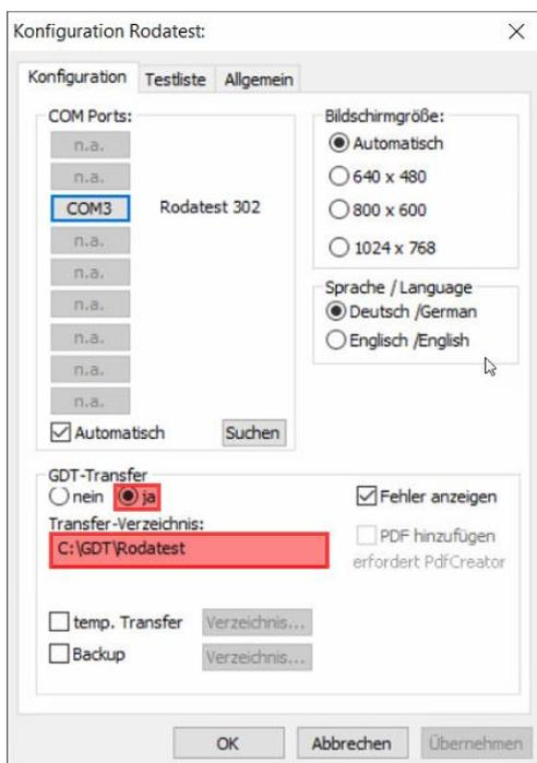
Abbildung 2: Konfiguration Rodatest 300
